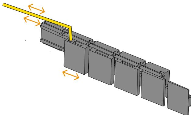
Für den Einsatz bei tiefen Wandstärken nutzen Sie den KONIK-Hilfshaken oder ein anderes adäquates Hilfsmittel um den KONIK Schiebekeil zu verschieben. Verwenden Sie hierfür die vorgesehene Öffnung im KONIK Schiebekeil.
