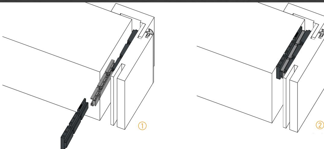
Platzieren Sie den KONIK Klebekeil auf dem Futterbrett. Nutzen Sie hierfür den Klebestreifen auf der Rückseite des Klebekeils. Der Abstand zu Wand kann mit KONIK Auffüllkeilen angepasst werden. Anschließend den KONIK Schiebekeil platzieren.
